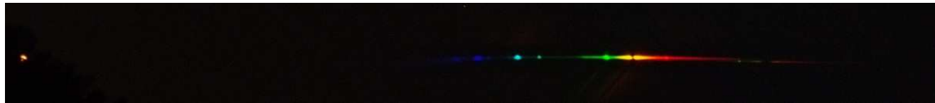
Spettro di luce di un lampione stradale al sodio in zona Pradespin di Lendinara (RO)
