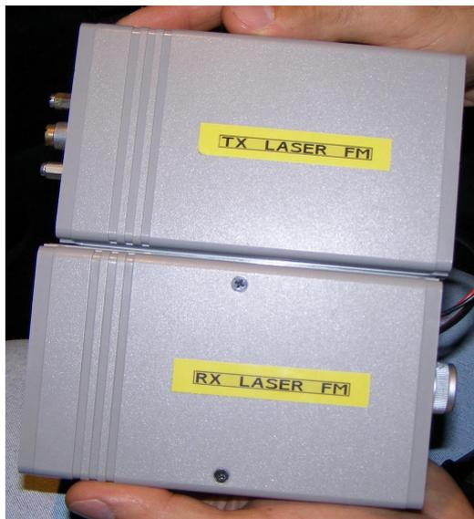
Alla conclusione delle prove, abbiamo constatato che il segnale VLF trasmesso via Laser, si mantiene pulito, non presenta interferenze sulla trasmissione (eccetto che un corpo non passi davanti al raggio Laser), la ricezione non presenta grossi disturbi dovuti alle apparecchiature vicine (notebook, il ricevitore a diodo Laser stesso, le fonti d'alimentazione, strutture metalliche...).
