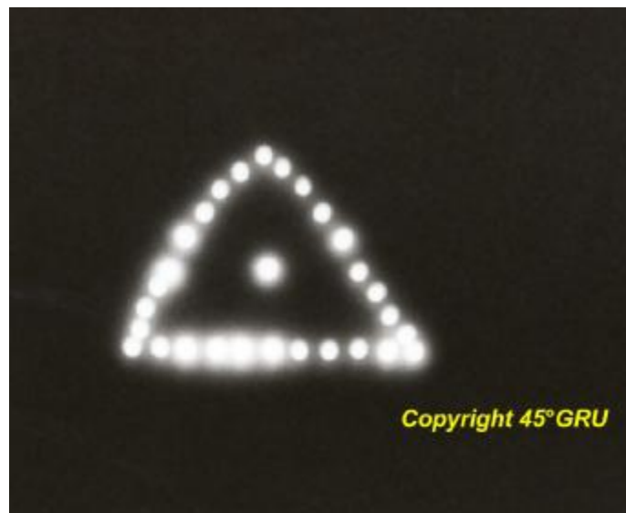
Foto 6: reflex NIKON F4 posizionata a circa 3mt. di distanza, pellicola Kodak Highspeed Infrared, ISO 320, niente filtro infrared, tempo di posa 4sec., F 5.6, ambiente totalmente buio.
