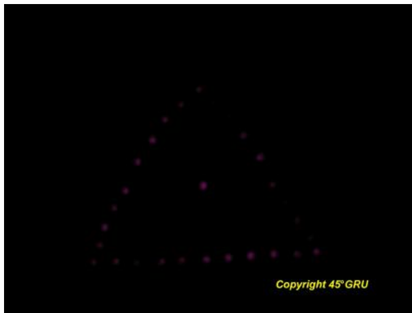
Foto 11: OLYMPUS SP-500 UZ digitale posizionata a circa 1mt. di distanza, ISO 80, filtro "nero" Hoya 72, tempo di posa 1/2sec., F 2.8, ambiente illuminato con luce artificiale al neon.
