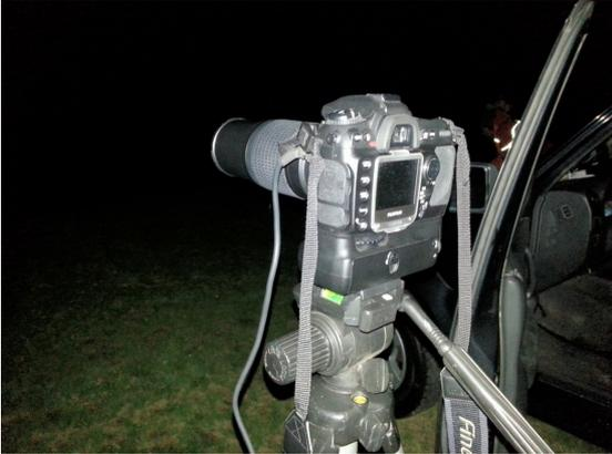
Una delle reflex per rilievi spettrometrici
